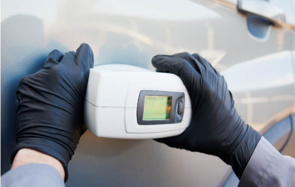
Figuur 5 Met kleurmeters kunnen we kleur eenvoudig omzetten in getallen
